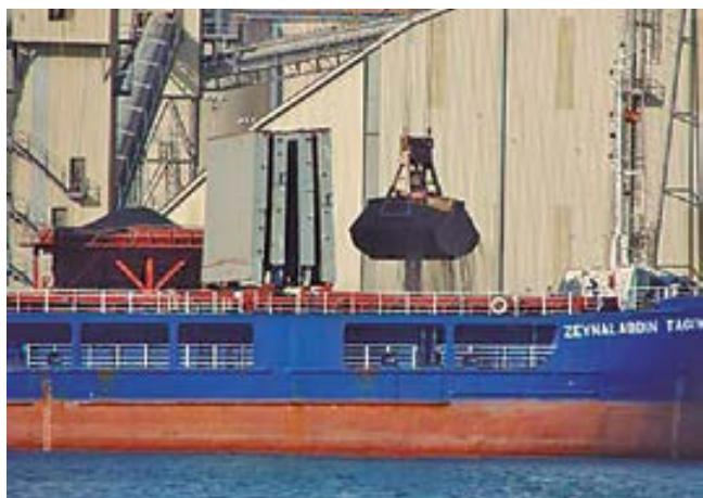
Alzado y traslación inapropiados de cuchara mientras aun rebose mercancía.
