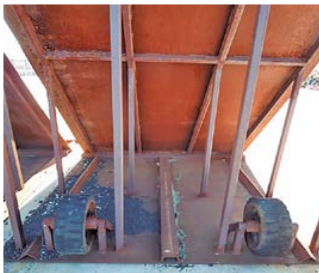
Detalles constructivos de rampas atrapa derrames
