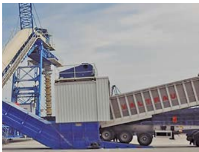
Cinta móvil para la carga de barcos con aspiración en el alimentador
