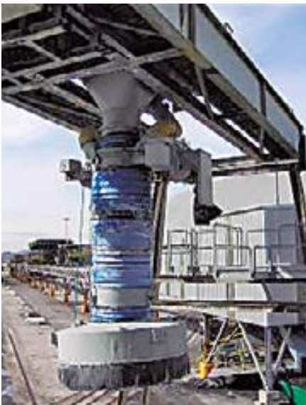
Tolva telescópica con aspiración para carga de barcos
