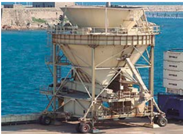
La boca de la tolva es lo bastante amplia para alojar la cuchara y apantallar la acción del viento.
