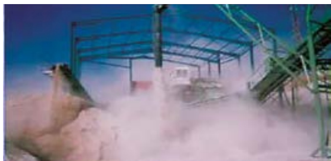
Implantación de un sistema de pulverización de agua con aditivos tensoactivos en sistema de cintas con apilador. Antes y después.
