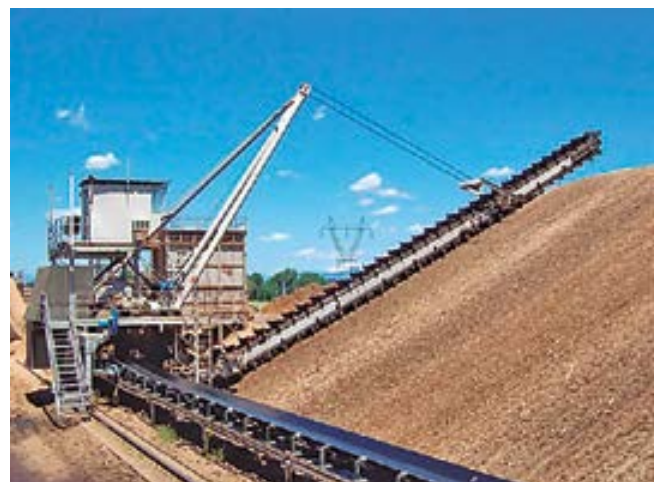
Levante mediante recogedor lineal de cadenas
