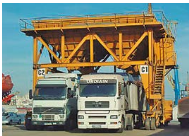
Las tolvas con doble cuerpo y varias toberas de descarga por cuerpo, permiten altos rendimientos, y previenen reboses en boca de tolva y derrames en carga de camión.
