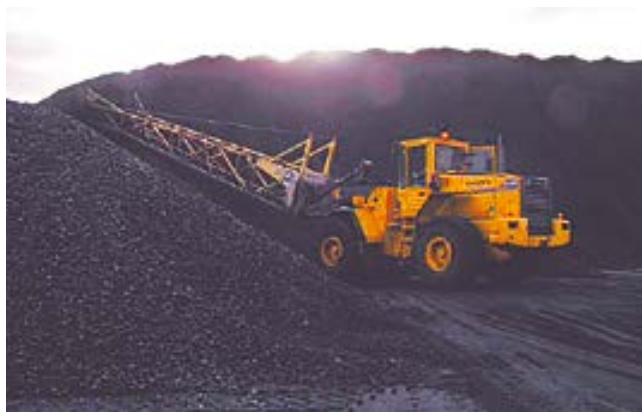
Acarreo desde muelle a parque de graneles con camión y remonte con empujador.
