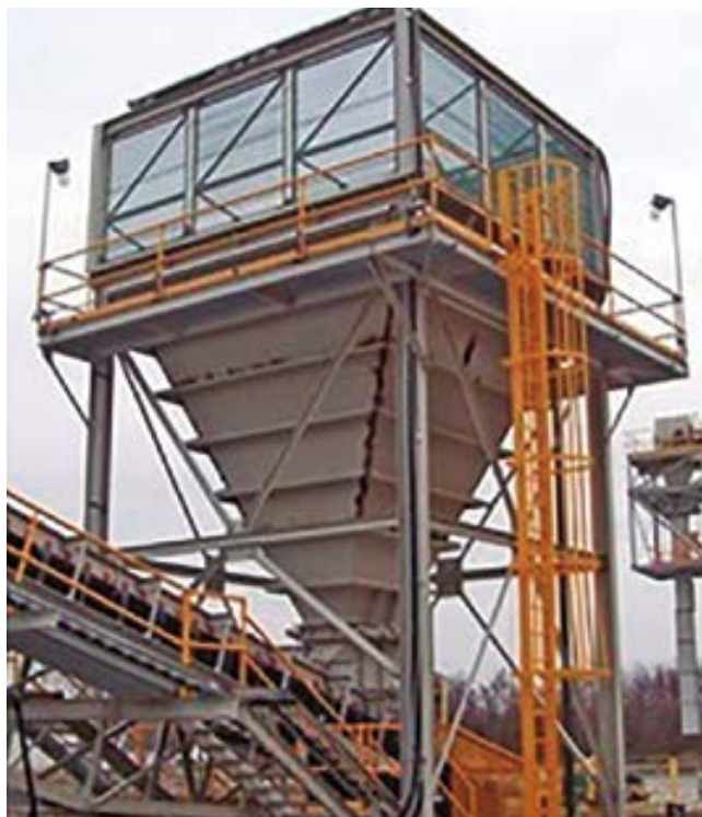
Tolva con pantalla porosa que evitar la formación de torbellinos en el interior.
