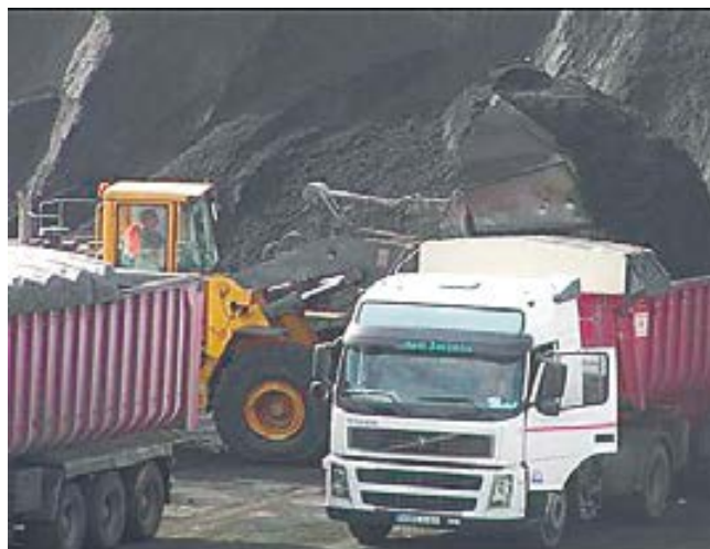
Las palas con cazo alto-volteador permiten limitar los derrames y aumentar la eficiencia de la operativa.
