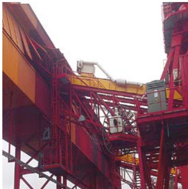
Trasferencia de descargador continuo a cinta carenada y con aspiración.
