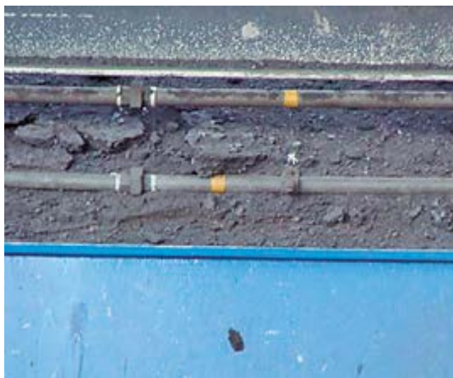
Los sistemas de pulverización de agua para controlar el polvo sólo son eficaces bajo un adecuado mantenimiento.
