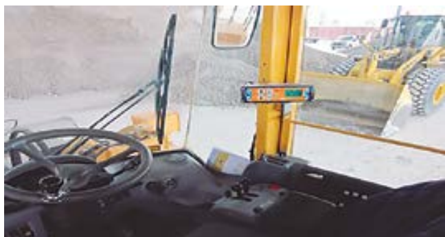
Pala cargadora con pesaje de cazo a bordo y control de la carga total vertida
