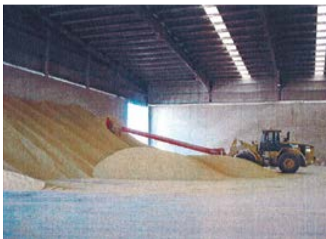
Carga de almacén con camión y pala. El uso del prolongador permite optimizar el espacio y reducir el deterioro de la mercancía.
