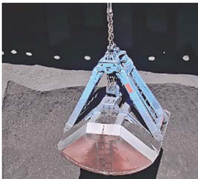
Descarga de carbón con cuchara sin tapa (izquierda) y descarga con cuchara con tapa lateral (derecha). El uso de cucharas con tapa limita la exposición de la mercancía a la acción del viento y reduce los derrames en el movimiento de la misma.
