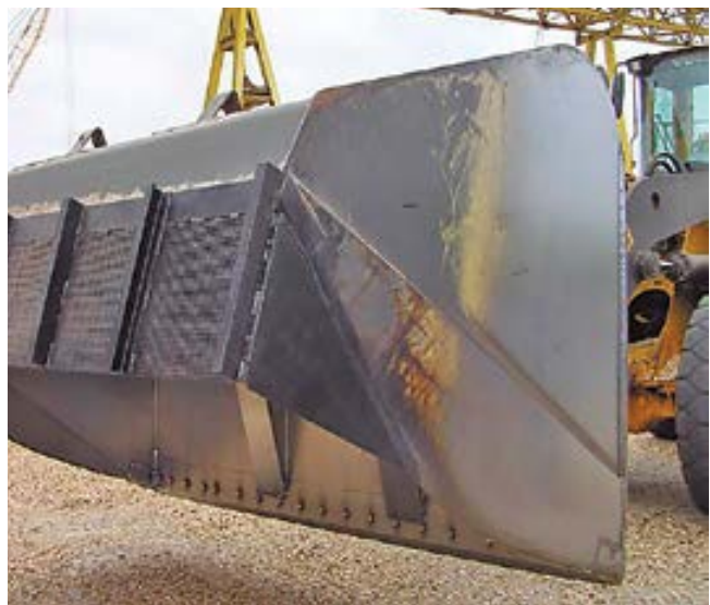
Pala con prolongación superior para evitar derrames en mercancías poco densas
