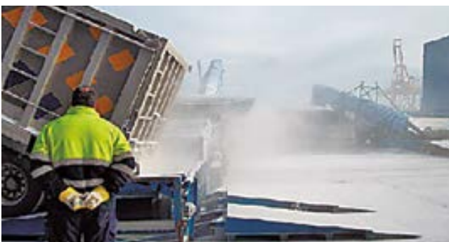
Carga de sulfato sódico con cinta convencional
