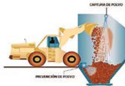
Diferencias en la ubicación y en los patrones de chorros entre inyectores que trabajan como sistemas de prevención e inyectores que actúan como sistemas de captura de polvo.
