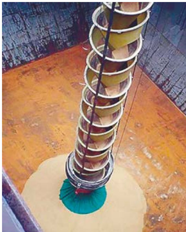
Tolvas telescópicas de cascada en cargador de camión y en cargador de barco. La corona de descarga permite limitar la dispersión de material en el punto de impacto.
