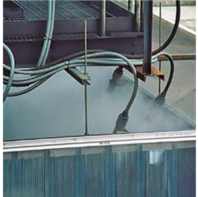
Carga de camión con tolva telescópica con anillo nebulizador apantallado con cortina.
