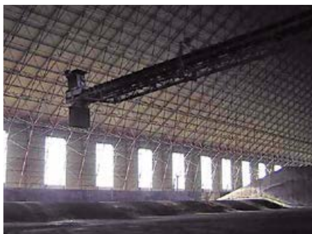
Carga de almacén mediante cinta y brazo apilador. La regulación de la altura del apilador permite reducir la generación de polvo.
