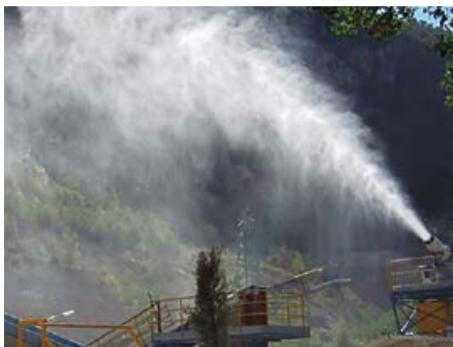
Pulverización de agua con turbina
