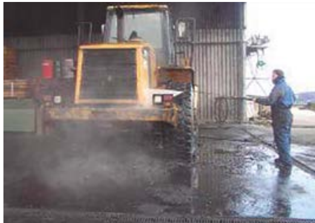
Limpieza de maquinaria en superficie con recogida perimetral de agua.
