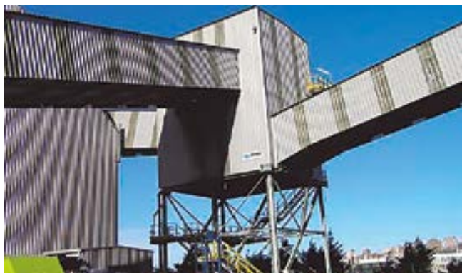
Cintas y transferencia entre cintas totalmente carenada.
