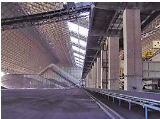
Carga de almacén mediante cinta y brazo apilador. La regulación de la altura del apilador permite reducir la generación de polvo.
