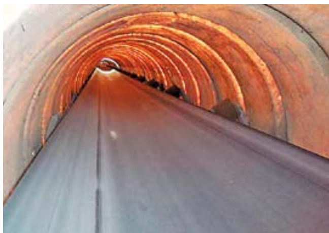
Cinta con capotado superior con elementos abatibles.
