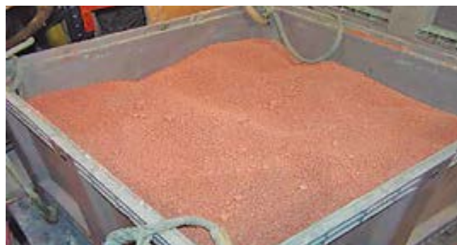
Absorbente (sepiolita) para recoger derrames accidentales de aceites.
