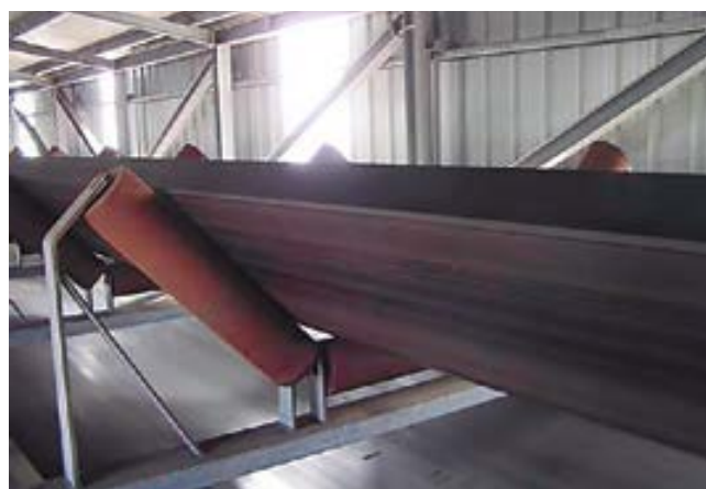
El correcto mantenimiento de rodillos evita ruidos y posibles roturas de cinta.
