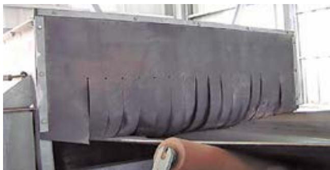
Los faldones previenen la salida de polvo y permiten un mejor funcionamiento de sistemas de aspiración o nebulización.
