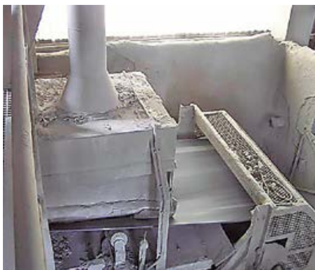
Trasferencia de sistema neumático a cinta.
