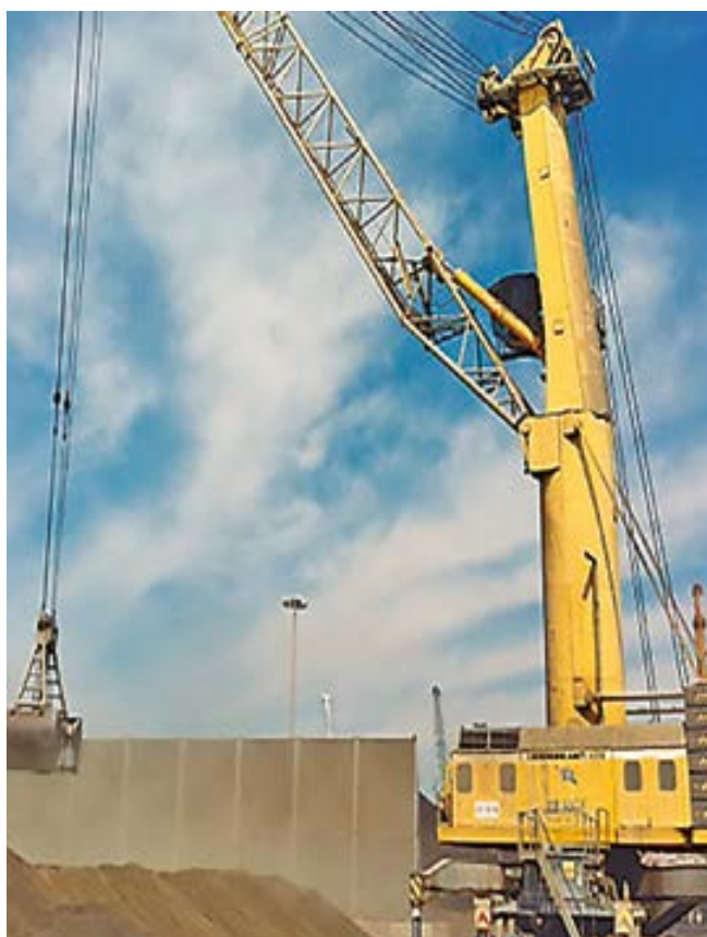
Descarga a primera línea protegida por pantalla atrapa polvo y cañones atomizadores.
