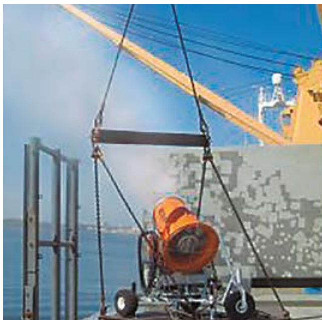
Las turbinas atomizadoras pueden apoyar la carga/descarga de barcos
