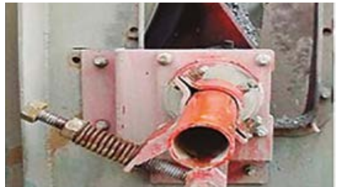
Rascador articulado capaz de ceder ante resaltes de la cinta.
