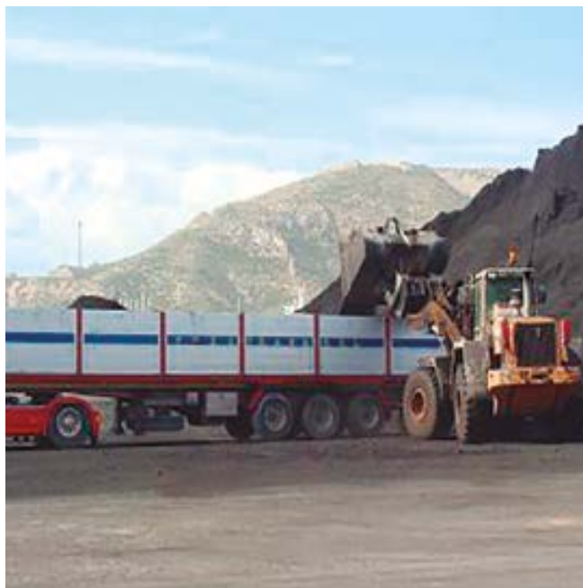
Levante y entrega de coke con pala y camión en muelle de uso común.
