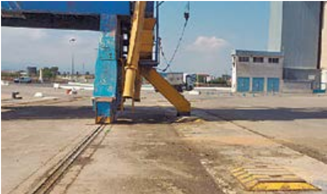
Descargador alimentando una cinta en galería subterránea.
