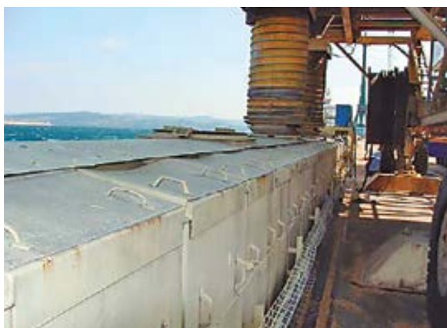
Transferencia de tolva a cinta carenada mediante manga de descarga. La hermeticidad evita la emisión de polvo, derrames y acceso de aves a la mercancía.
