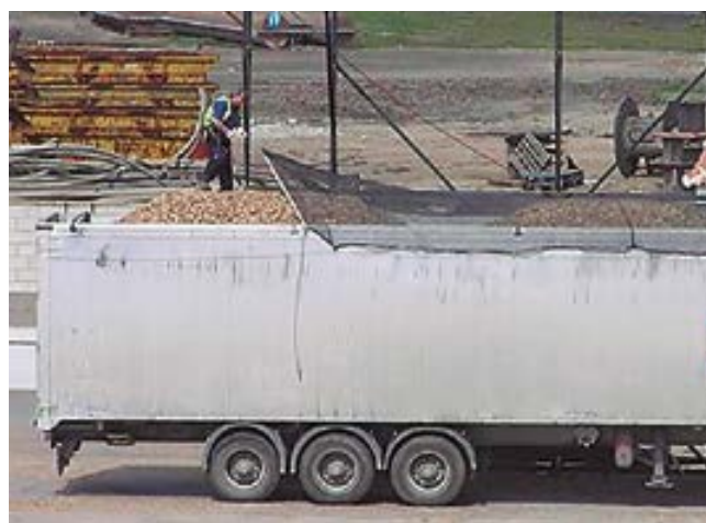
Caja con toldo corredero accionable mediante manivela desde el suelo
