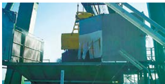
Inyectores de agua pulverizada en tolva protegida por pantallas en un descargador.
