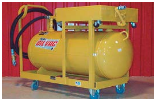
Equipo de recogida de aceite mediante bandeja y aspiración desde la bandeja.
