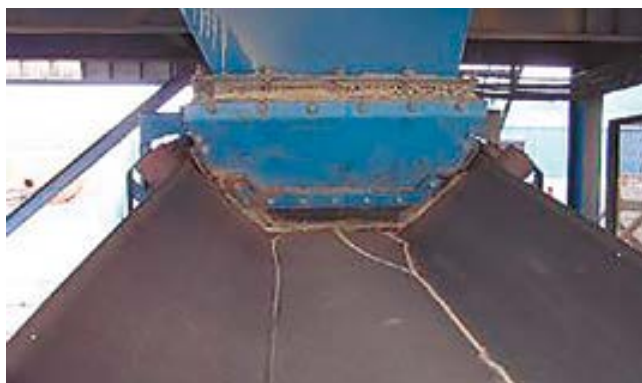
Un ajuste demasiado rígido acelera el deterioro de la cinta.
