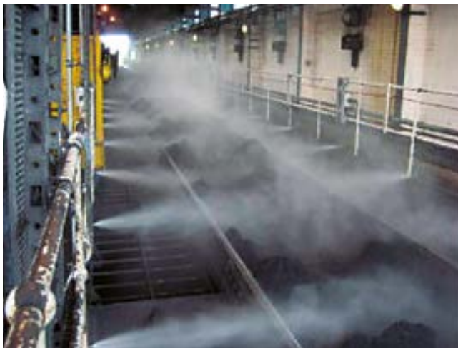
Zonas de descarga de vagones y camiones apantalladas, con atomizadores.
