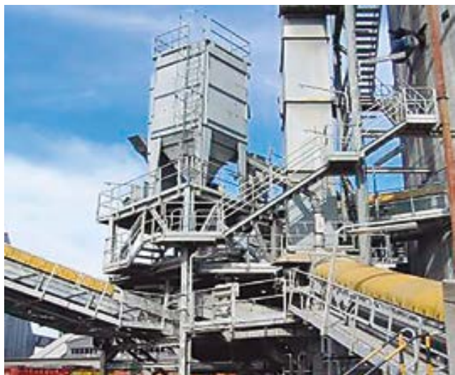
Filtro en transferencia de cinta a elevador de cangilones
