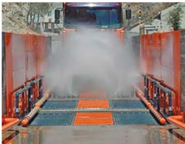
Secuencia de lavado en lavaruedas de paso continuo.
