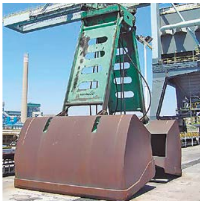
Cuchara con tapas para carbón movida en pórtico cargador
