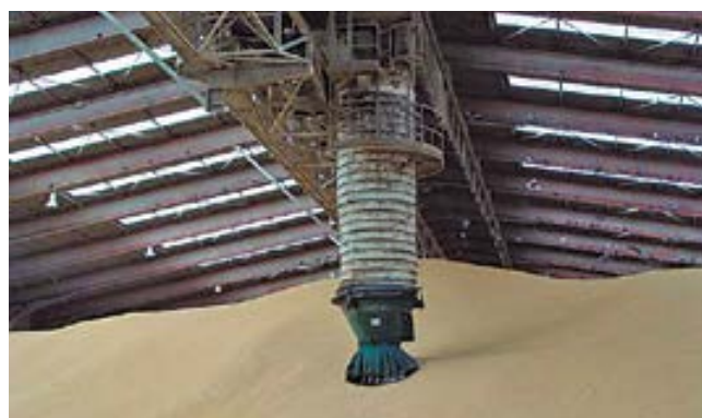
Descarga cenital desde cinta con tripper y descarga desde cinta con tripper y tolva telescópica. La tolva telescópica de cascada limita la emisión de partículas y el deterioro de la mercancía.
