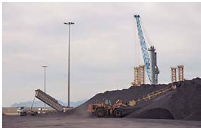
Acarreo desde muelle a parque de graneles con camión y remonte con empujador.
