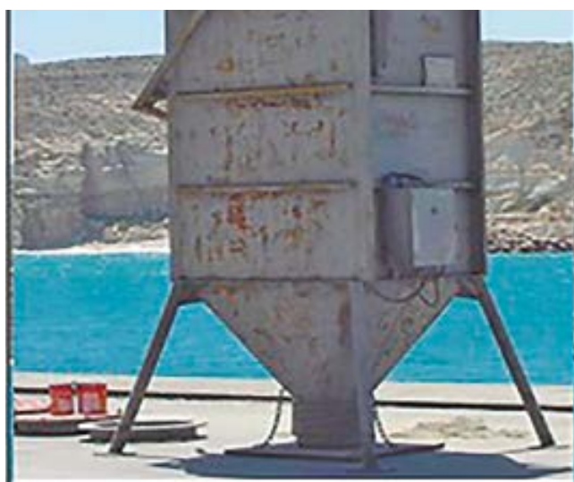
Filtro de partículas portátil insertable en la bodega de barcos cargados por medios neumáticos.
