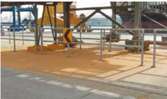
Si no se realiza un rascado adecuado de la cinta la mercancía adherida cae en el retorno de la cinta
