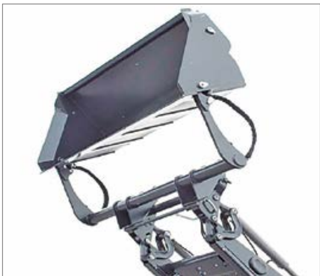
Cazo de alto volteo con hidráulicos auxiliares adaptado a pala convencional
