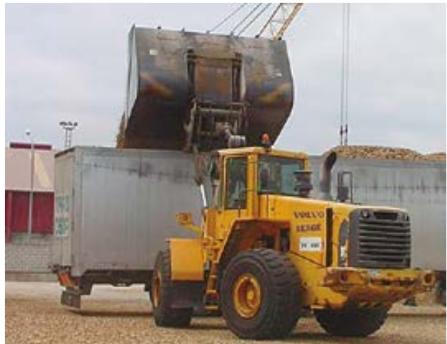
Operativa de carga de carbón y de viruta de madera con cazos de alto volteo. Este tipo de sistemas permiten un mejor "encaje" de la pala en la caja limitando derrames
