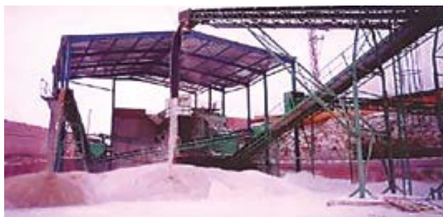
Implantación de un sistema de pulverización de agua con aditivos tensoactivos en sistema de cintas con apilador. Antes y después.
