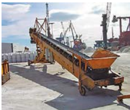
Cinta móvil tradicional: Elevador, Tobogán y Alimentador
