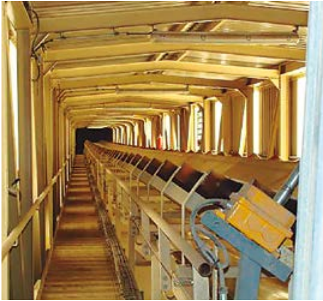
Vista interior y exterior de una cinta en galería, utilizada para el movimiento horizontal de cereales entre muelle y almacén.
