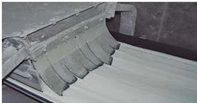
Los faldones previenen la salida de polvo y permiten un mejor funcionamiento de sistemas de aspiración o nebulización.
