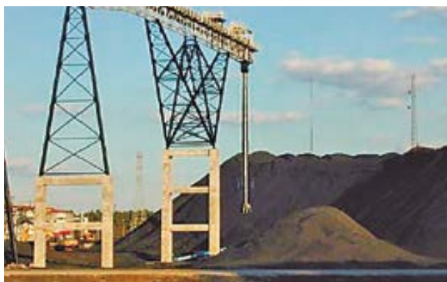
Formación de acopio mediante tubo telescópico
