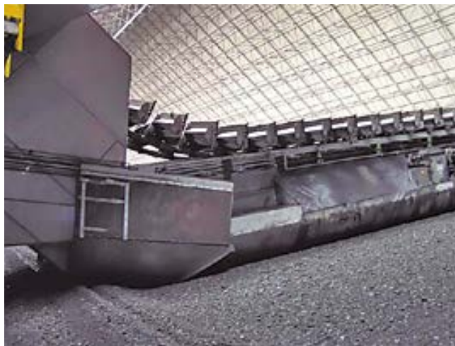
Recogedor lineal de cadenas con faldones.
