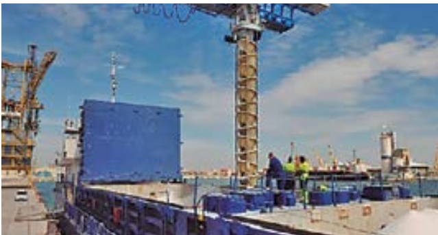
Cinta móvil de alta eficiencia ambiental con alimentador carenado con aspiración, elevador carenado, y descarga con tolva telescópica de cascada.
