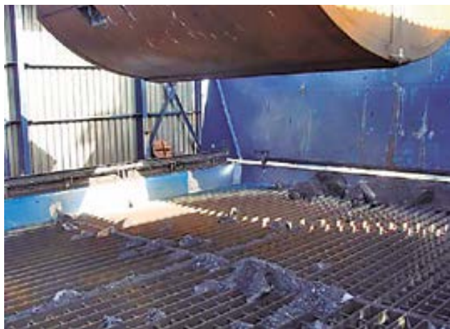
Tolva de descargador apantallada.
