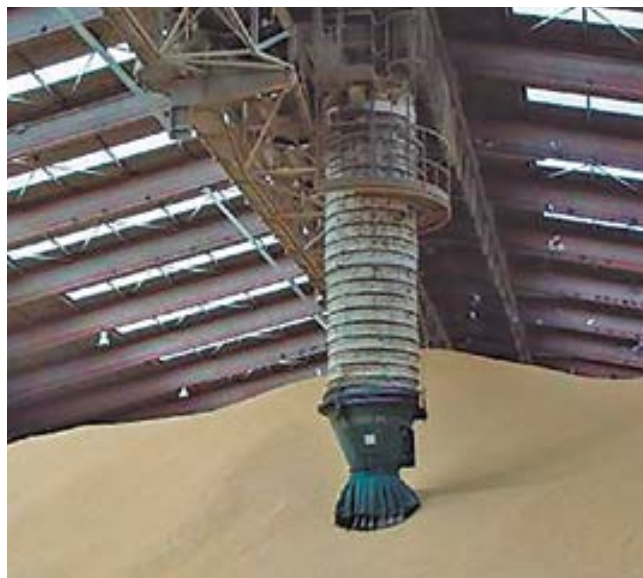
Atmósfera libre de polvo en descarga de trigo en almacén mediante cinta cenital, tripler y tolva telescópica de cascada.
