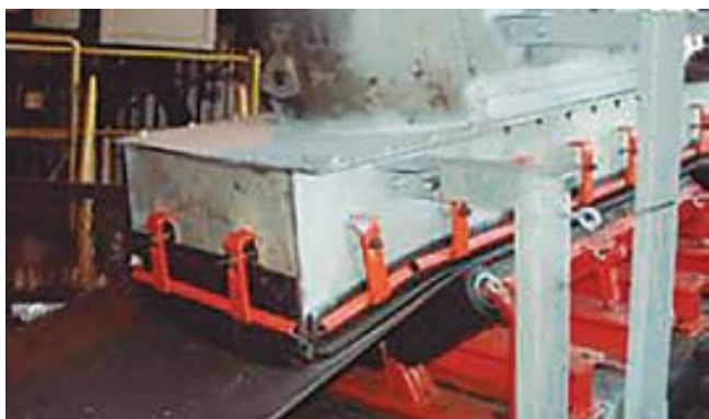
Caja selladora que evita la salida de mercancía por la parte trasera.
