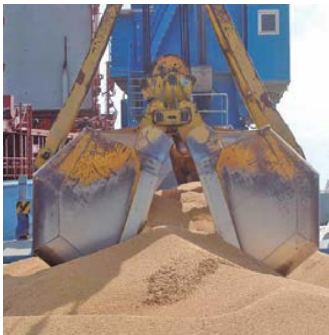
Carga con cuchara de cereales desde muelle de uso común.
