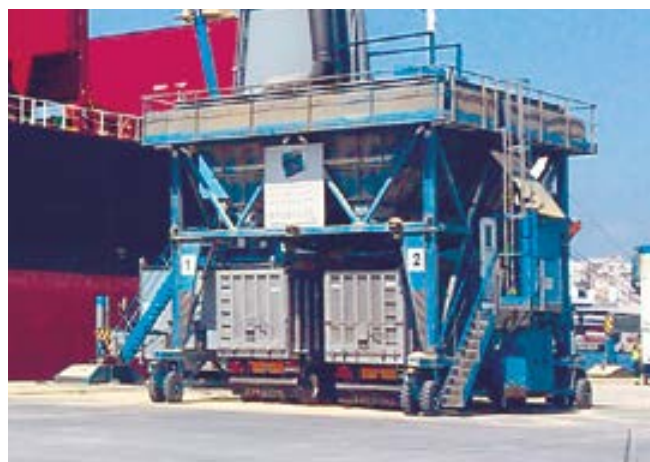
Las tolvas con doble cuerpo y varias toberas de descarga por cuerpo, permiten altos rendimientos, y previenen reboses en boca de tolva y derrames en carga de camión.
