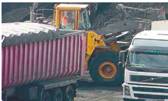
Trasporte horizontal desde muelle a parque de graneles en camión con toldo automático
