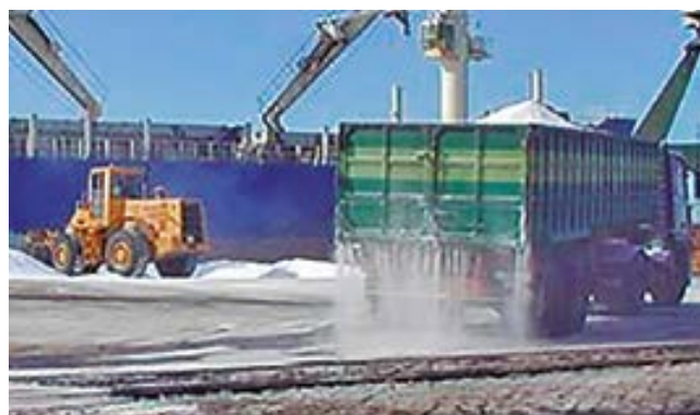
Derrames por estado no adecuado de los cierres de caja.
