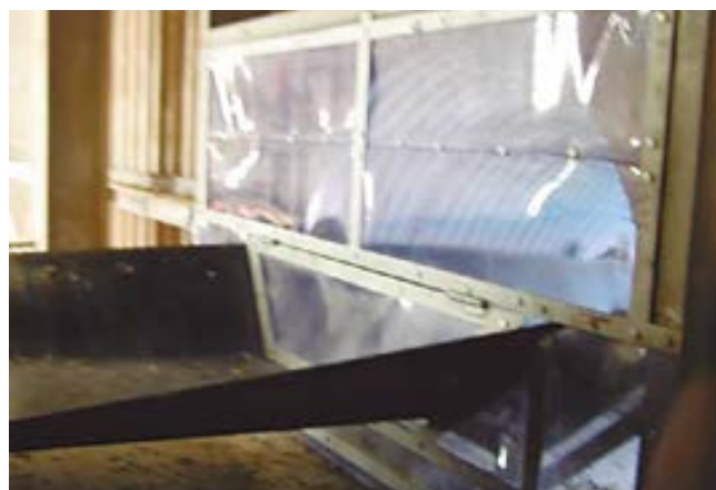
Salida de cinta carenada con trampilla articulada para evitar el acceso de aves
