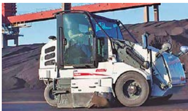
La limpieza de las zonas de tránsito del parque de graneles permite limitar las emisiones por rodadura.
