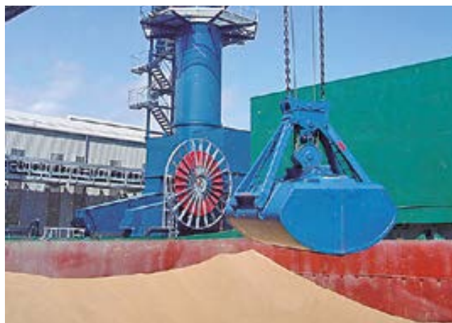
Alzado correcto de cuchara esperando que finalice el rebose en la bodega del barco.
