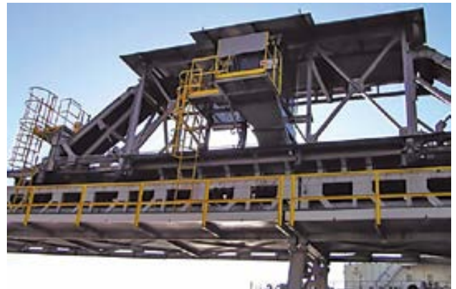
Mesa de carga. Tolva y encauzador móvil a lo largo de la cinta.
