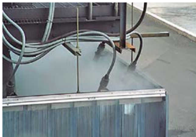
Control de emisiones en carga de camión mediante niebla seca
