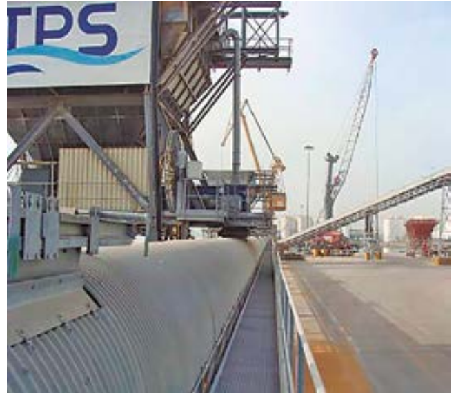
Cinta paralela a muelle con registros para acoplar el brazo de descarga carenado de una tolva.
