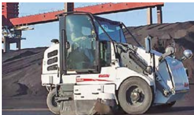
Barredora con sistema de supresión de emisiones de polvo por nebulización de agua.
