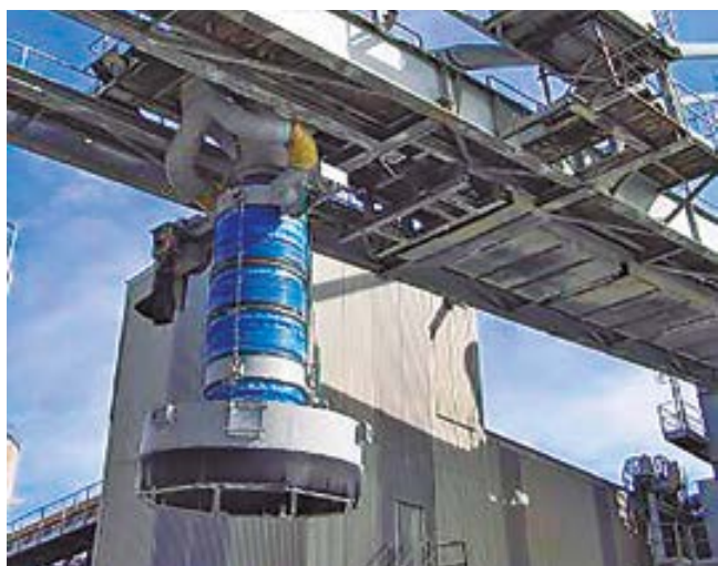
Tolva telescópica con corona y canal concéntrico de aspiración.
