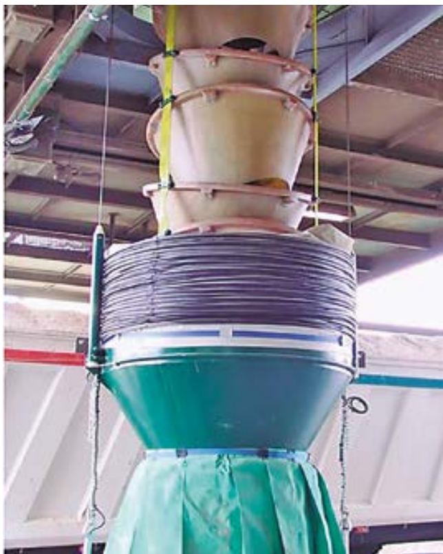
Tolvas telescópicas de cascada en cargador de camión y en cargador de barco. La corona de descarga permite limitar la dispersión de material en el punto de impacto.
