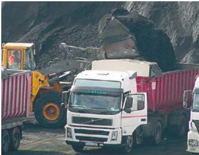
Operativa de carga de carbón y de viruta de madera con cazos de alto volteo. Este tipo de sistemas permiten un mejor "encaje" de la pala en la caja limitando derrames
