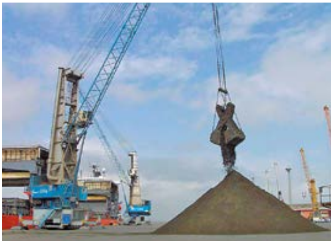
La cuchara se abre por debajo de la boca de la tolva para evitar emisiones.
