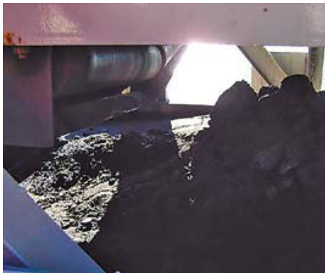
La mercancía adherida a la cinta precipita en los puntos de paso de rodillo, pudiendo ocasionar el atasco de éstos.
