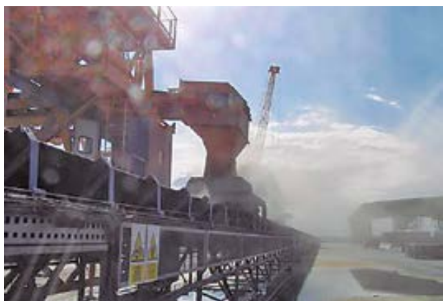
Un ajuste inadecuado del faldón de la tolva de descarga con la cinta puede provocar emisión en la transferencia
