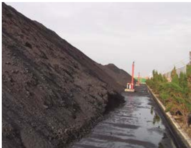
Aspersión con cañones de agua fijos.
