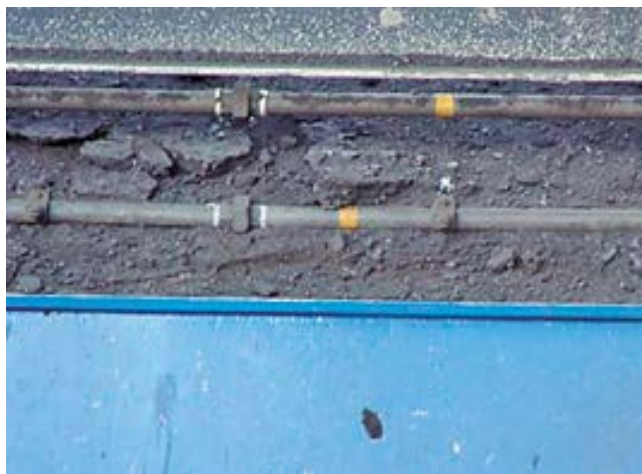
Pulverizador de agua en tolva del cargador.
