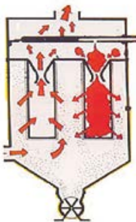
Limpieza mediante chorro de aire a presión
