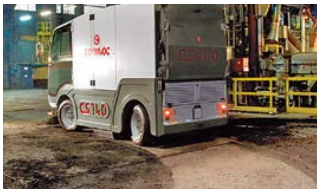
Barredora con sistema de control de emisiones por nebulización y aspiración.
