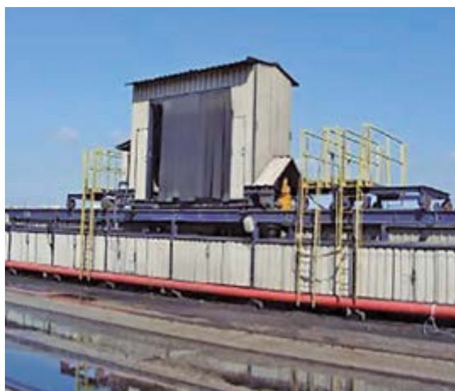
Estructura carenada y con cortinas para apantallar transferencia de tolva a cinta
