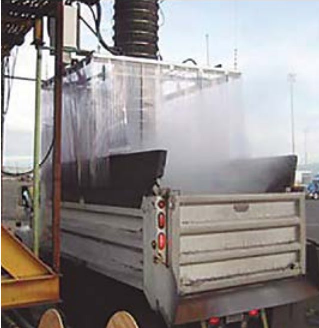
Carga de camión con tolva telescópica con anillo nebulizador apantallado con cortina.
