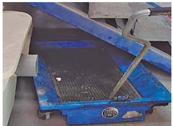
Control de derrames en mantenimientos
