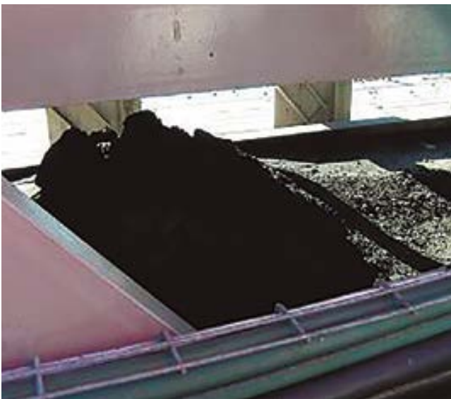
La mercancía depositada en la cara interior de la cinta puede adherirse a los rodillos, y dar problemas de centrado.
