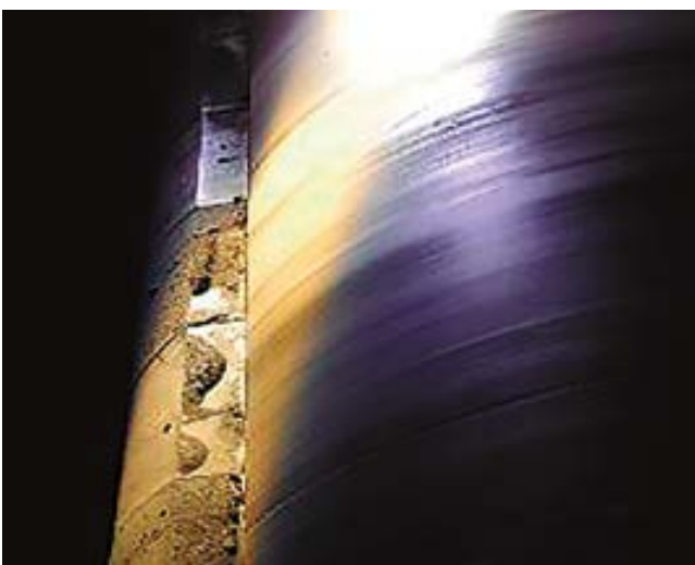
Un rascador adecuado y bien mantenido reduce la cantidad de mercancía adherida al retorno de la cinta
