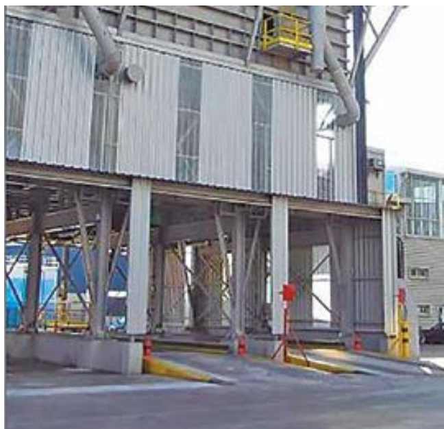
Cargadero automático con dosificador de carga que evita retornos de camiones por exceso de carga.
