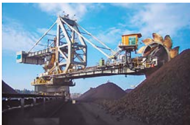
Tareas de apilado y levante con rotopala en parque de graneles.
