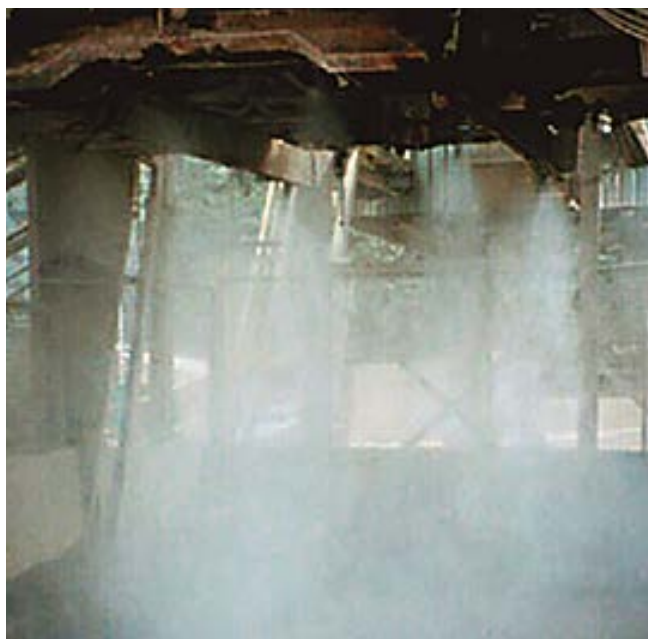
Tolva con atomizador en zona de carga de camiones
