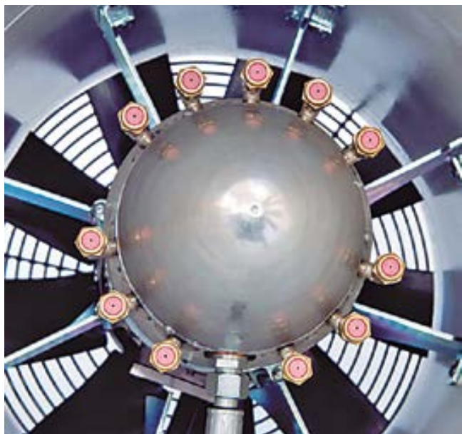
El agua pulverizada generada por los inyectores es arrastrada por una turbina de aire.
