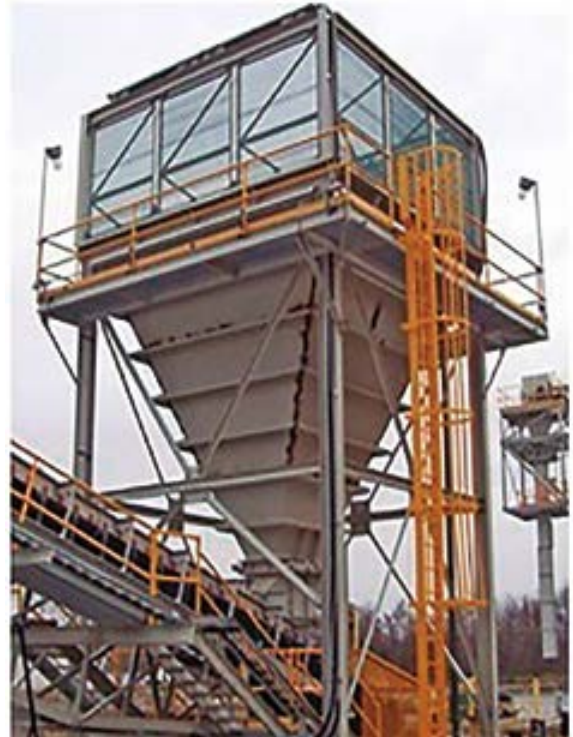
Boca de tolva apantallada con malla porosa para evitar turbulencias y nebulización
