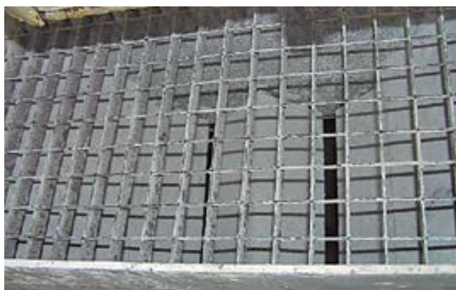
Rejilla con flex-flap en tolva subterránea para reducir la salida de polvo.
