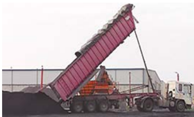
Trasporte horizontal desde muelle a parque de graneles en camión con toldo automático
