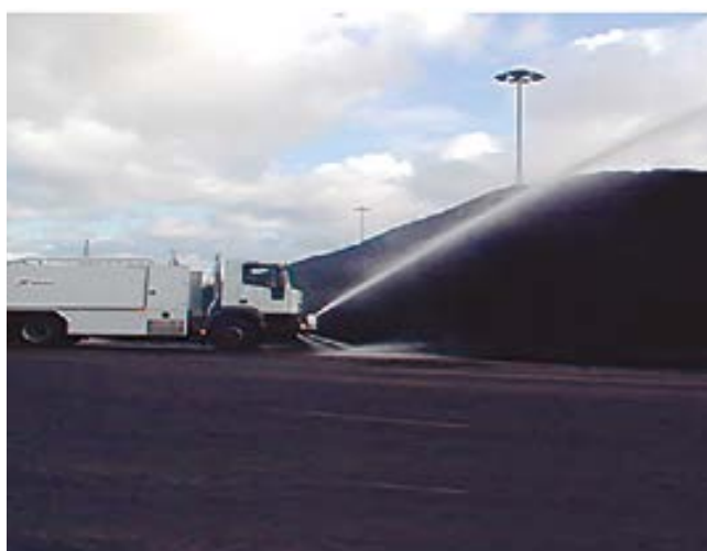
Aspersión con camión cisterna
