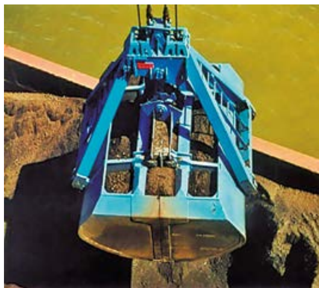
Descarga de carbón con cuchara sin tapa (izquierda) y descarga con cuchara con tapa lateral (derecha). El uso de cucharas con tapa limita la exposición de la mercancía a la acción del viento y reduce los derrames en el movimiento de la misma.
