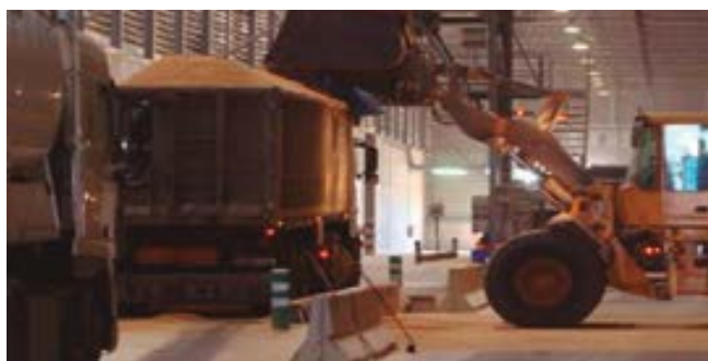
Separación de zona de operación de pala y zona de tránsito de camiones
