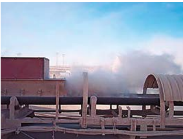
Efecto de la instalación de un sistema nebulizador en el encauzador de una transferencia entre cintas. Antes y después.
