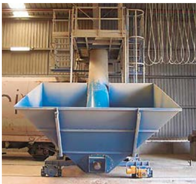
Carga mediante pala y tolva con tornillo sin fin en el interior de un almacén.
