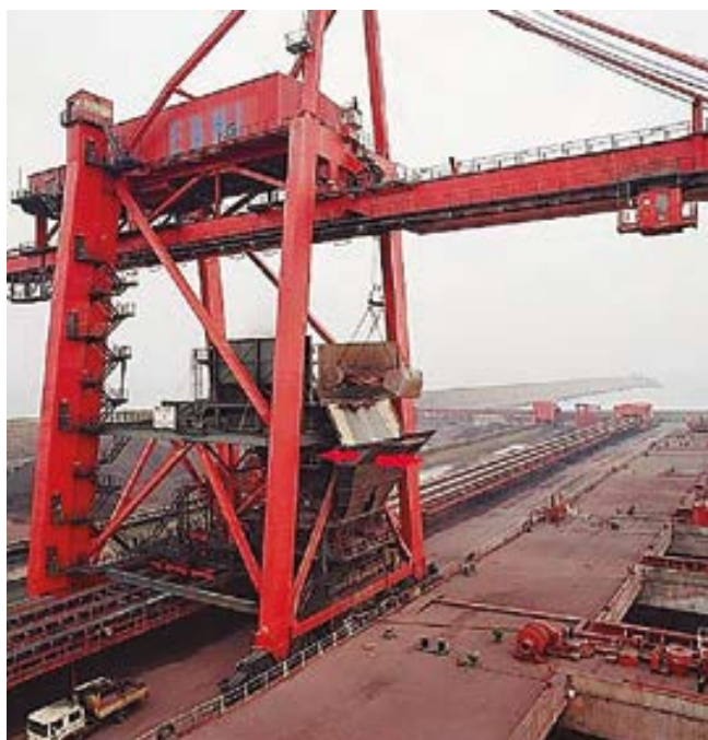
Bandejas atrapa derrames en grúa pórtico
