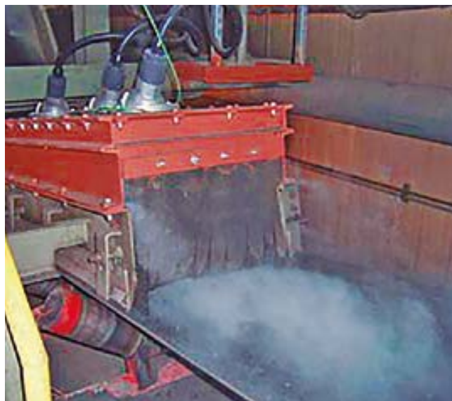
Nebulizadores en punto de vertido y en el encauzador de una transferencia entre cintas
