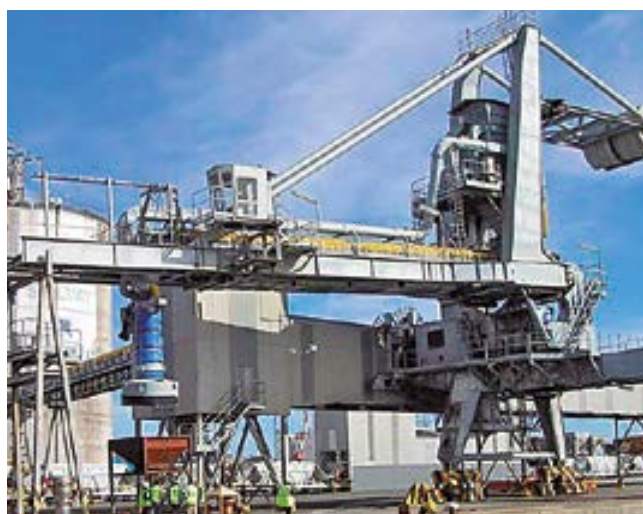
El descargador neumático (izquierda) y el cargador continuo con manga de descarga (derecha). El dimensionamiento adecuado de la capacidad de operación de los equipos permite compatibilizar rendimientos y desempeño ambiental.
